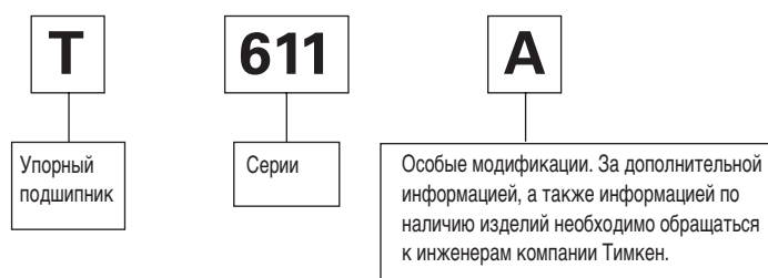
Рис. 41. Система обозначений упорных конических подшипников.
