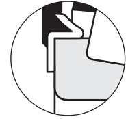
Рис. 2. Контакт широкого торца внутреннего кольца и упорного заплечика вала (без контакта с уплотнением).
