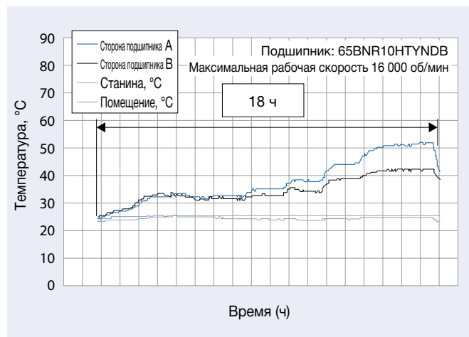
Рис. 3.1 Изменения температуры при работе с постоянной скоростью
