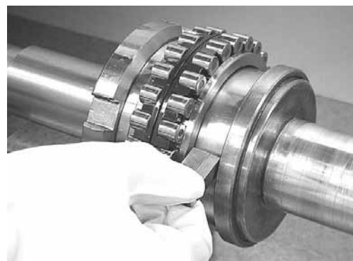
Рис. 1.15 Измерение ширины дистанционного кольца
