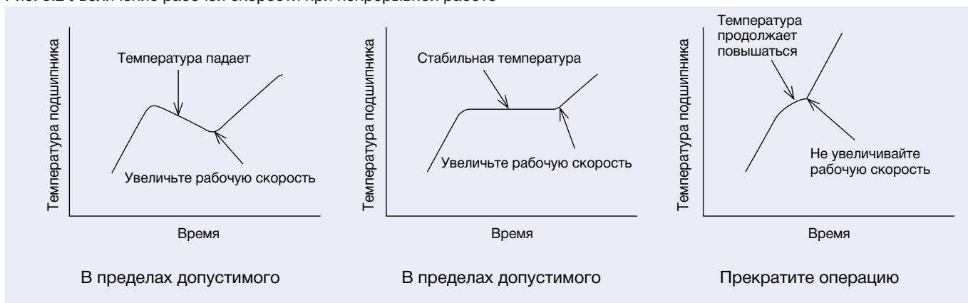
Рис. 3.2 Увеличение рабочей скорости при непрерывной работе
