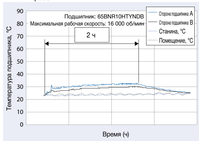
Рис. 3.3 Изменение температуры при прерывистом режиме работы
