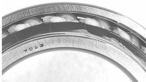
Рис. 1.20 Наполненный смазкой цилиндрический роликовый подшипник
