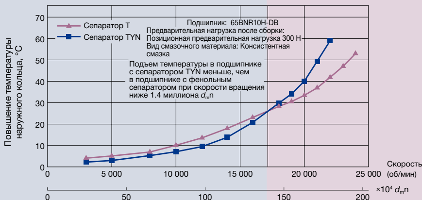
Результат эксплуатационных испытаний сепаратора
