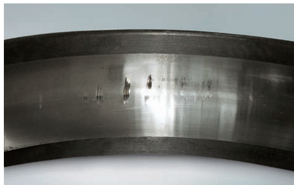
Фото 12.2 Деталь: Наружное кольцо с Фото 12.1 Симптом: Ложное бринеллирование на дорожке качения Причина: Вибрации от внешнего источника в неподвижном состоянии
