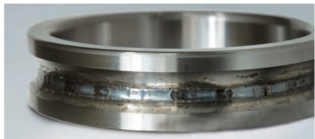
Фото 14.3 Деталь: Внутреннее кольцо радиально-упорного шарикового подшипника Симптом: Изменение цвета следов вращения, оплавливание на интервале, соответствующем шагу шариков Причина: Чрезмерный предварительный натяг
