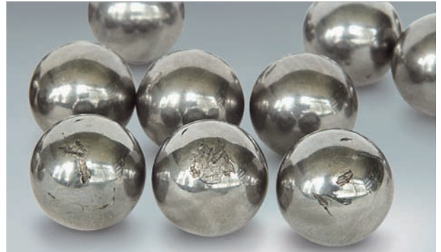
Фото 1.6 Деталь: Шарик с фото 1.4 Симптом: Усталостное отслаивание поверхности шарика Причина: Выбоины в результате ударной нагрузки в неподвижном состоянии
