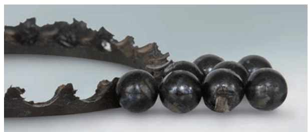
Фото 14.5 Деталь: Шарики и сепаратор с фото 14.3 Симптом: Сепаратор оплавился, шарики изменили цвет и оплавлились Причина: Чрезмерный предварительный натяг
