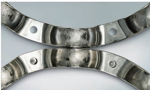
Фото 3.7 Деталь: Сепаратор радиального шарикового подшипника Симптом: Задиры в ячейках сепаратора из прессованной стали Причина: Попадание инородных частиц
