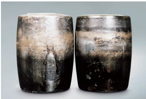
Фото 14.2 Деталь: Бочкообразные ролики с фото 14.1 Симптом: Изменение цвета и оплавливание поверхности качения ролика, адгезия частиц изнашивания сепаратора Причина: Недостаточная смазка
