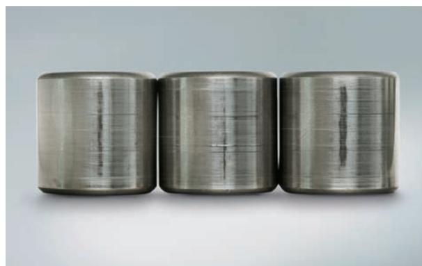
Фото 12.4 Деталь: Ролики цилиндрического роликового подшипника Симптом: Ложное бринеллирование на поверхности ролика Причина: Вибрации от внешнего источника в неподвижном состоянии
