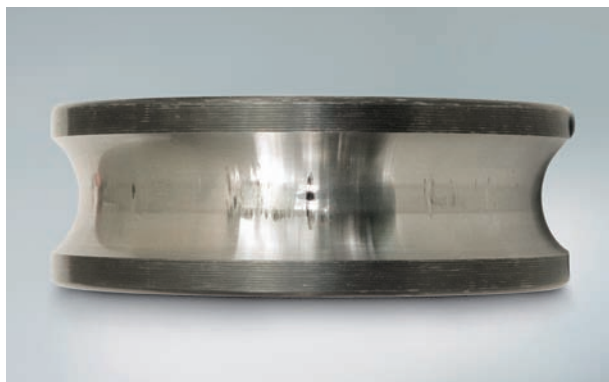
Фото 12.1 Деталь: Внутреннее кольцо радиального шарикового подшипника Симптом: Ложное бринеллирование на дорожке качения Причина: Вибрации от внешнего источника в неподвижном состоянии
