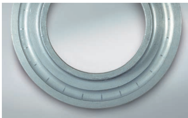
Фото 12.3 Деталь: Наружное кольцо упорного подшипника качения со сферическими роликами Симптом: Ложное бринеллирование поверхности следов вращения, соответствующее шагу шариков Причина: Циклическая вибрация с малым углом осцилляции
