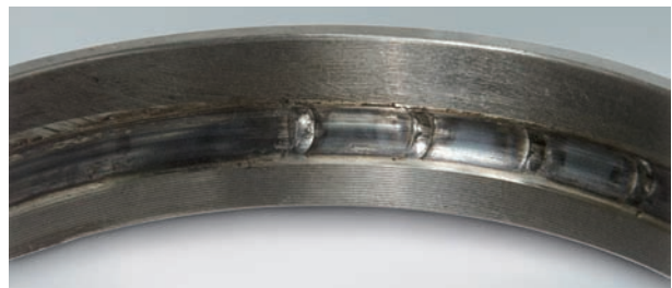
Фото 14.4 Деталь: Наружное кольцо с фото 14.3 Симптом: Изменение цвета следов вращения, оплавливание на интервале, соответствующем шагу шариков Причина: Чрезмерный предварительный натяг
