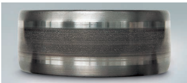
Фото 15.3 Деталь: Внутреннее кольцо подшипника качения с цилиндрическими роликами Симптом: Характерный полосовой след электрохимической коррозии, сопровождаемый следами язвенной коррозии на поверхности следов вращения
