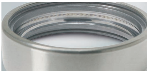
Фото 15.6 Деталь: Наружное кольцо шарикового подшипника Симптом: Рефление на поверхности следов вращения (Высокой частоты)
