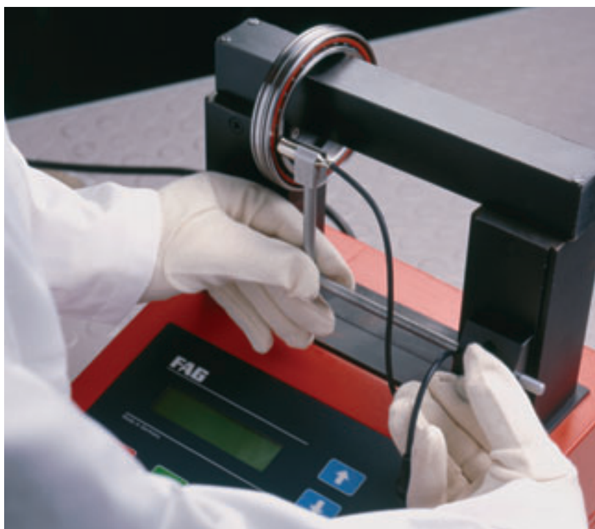
40: Calentamiento de un rodamiento con ayuda de un calentador inductivo
